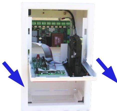
La porte est bloquée par un boulon M6 (clé de 10), situé en bas à droite. Une fois l'installation terminée, le boulon doit être serré manuellement.
