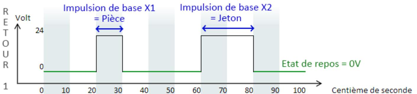
Sur un même retour (le 1), le centralisateur reçoit une impulsion de 10 centièmes de secondes (impulsion de base multiplié par 1) qui représente le type Pièce et une autre impulsion de 20 centièmes de secondes (impulsion de base multiplié par 2) qui représente le type Jeton. Au final sur ce même retour, nous avons reçu 1€ en pièce et 1€ en jeton.
